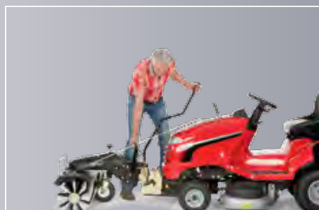
2 sec. Het werktuig aankoppelen. (geen gereedschap nodig)
