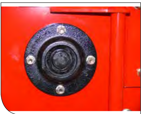
Zwaar gelagerde rotor (gietijzeren lager blokken)
